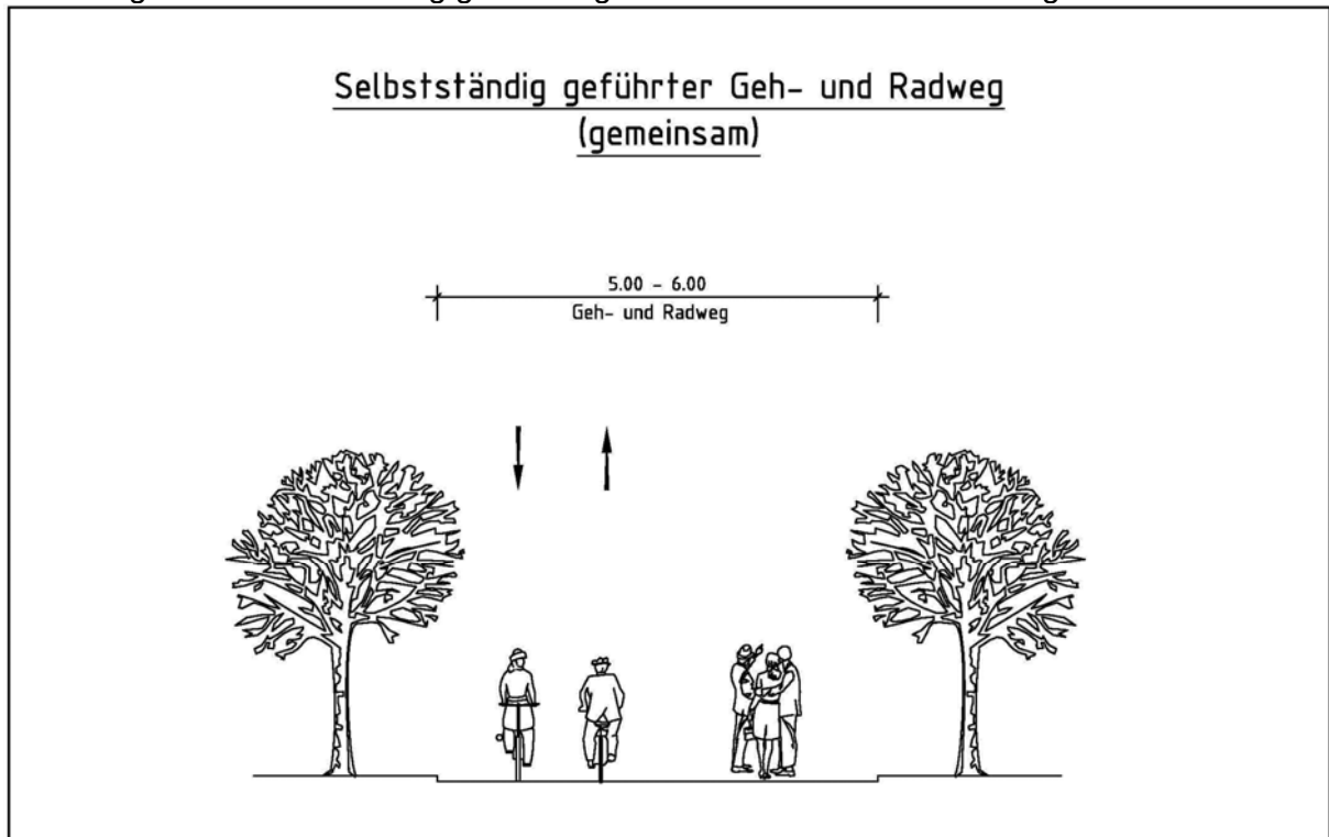
Abbildung 2-15: Selbstständig geführter gemeinsamer Geh- und Radweg
